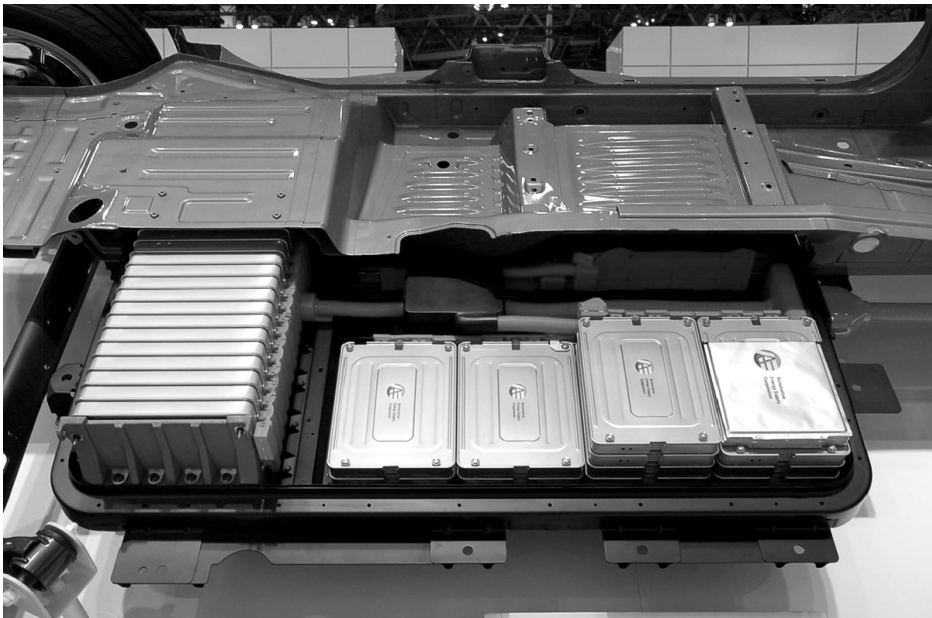
資料5 3 リチウムイオンバッテリーのモジュール構造
